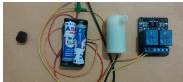
Gambar 3. Aktuator (Buzzer, Relay dan Pompa air)
